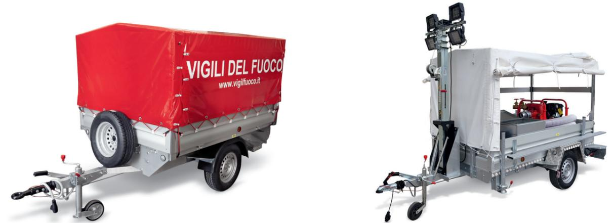
Completo di n.4 piedini stabilizzatori, con gancio sferico o in alternativa gancio ULPIO, centina personalizzabile, apribile su 4 lati e amovibile. Allestito con Motopompa da svuotamento per uso emergenza, torre faro in acciaio H. 6 m, elettropompa sommergibile passaggio corpi solidi, elettropompa sommergibile filo pavimento aspirazione fino a 1 mm, generatore inverter benzina, ed infine accessori per aspirazione/mandata motopompa ed elettropompe di tipo UNI.
